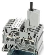
La fiche de test (2009-182) est appropriée pour les séries 2000 à 2016 pour le raccordement sans outil des fils d'essai individuels jusqu'à 2,5 mm<sup>2</sup>.
