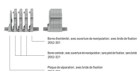
Exemple de barrettes à bornes à 4 pôles; avec ouverture de manipulation; avec brides de fixation
