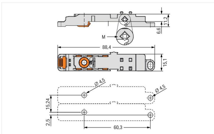
M = Tôle de fixation pour le blocage axial sur le rail
