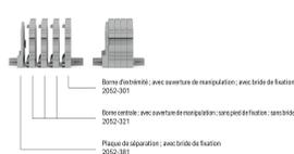
Exemple de barrettes à bornes à 5 pôles; avec ouverture de manipulation; avec brides de fixation à encliqueter (sans brides de bornes)
