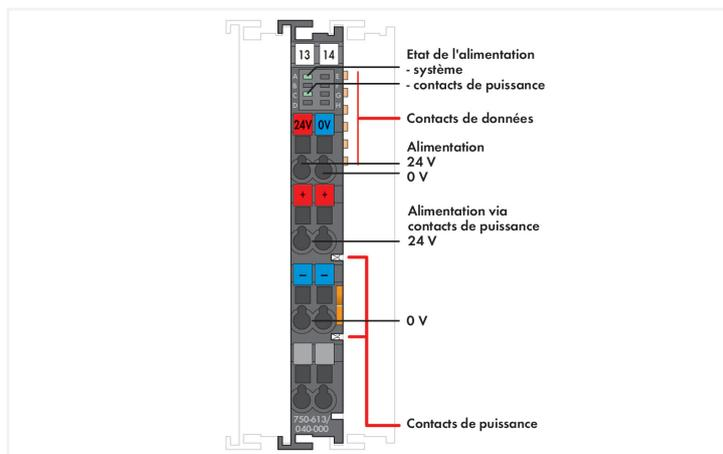
La borne d'alimentation avec alimentation du bus interne augmente la capacité d'alimentation en courant interne de 2 A pour les noeuds nécessitant un courant important ( somme des courants internes des bornes).
