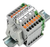
Bande de repérage (2009-110) insérée dans le logement de repérage avec la symbole du pont utilisé (contact de pontage en étoile 2000-405/011-000) (ici, l'exemple des bornes avec poussoir)
