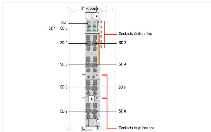
Cette borne de sorties digitales (T.O.R.) de seulement 12 mm de largeur dispose de 8 canaux. L'automate programmable transmet ses signaux de commande aux actionneurs connectés par l'intermédiaire des bornes de sorties digitales. Toutes les sorties sont protégées contre les courts-circuits. La séparation galvanique bus de terrain/bornes est assurée par des optocoupleurs.
