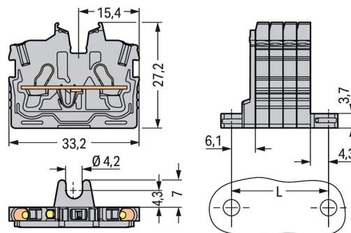
Borne de passage série 2050 avec Push-in CAGE CLAMP®
