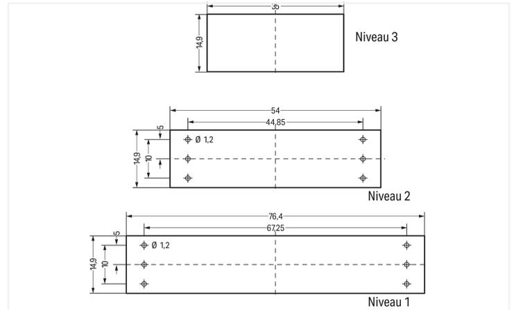
Dimensions des circuits imprimés, pour montage vertical : (épaisseur de circuits imprimés max. 1,5 mm) dans le niveau 1; (épaisseur de circuits imprimés max. 1 mm) dans les niveaux 2 et 3
