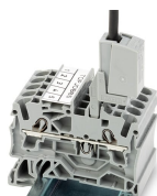
La fiche de test (2009-182) est appropriée pour les séries 2000 à 2016 pour le raccordement sans outil des fils d'essai individuels jusqu'à 2,5 mm 2 .
